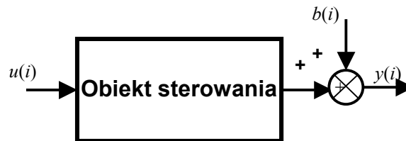
Rys. 1. Schemat blokowy dyskretnego obiektu sterowania.
